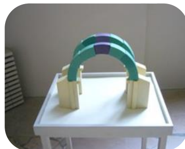
Étapes de la construction d'un arc en plein cintre.
